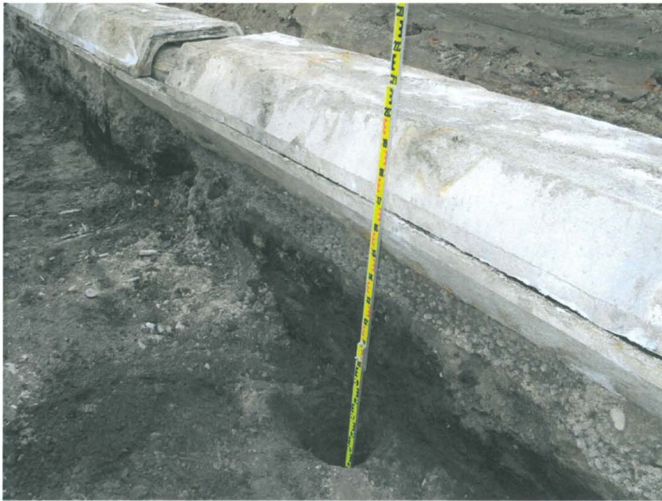
Kuva 133. Kirkkokatu, läntinen osa. Kaukolämpitysputken betonirakenteen profiilin kohdalle kaivettiin koekuoppa ( havaintopiste KL 3 ). Kuvaussuunta NW. 12.11.2009.
