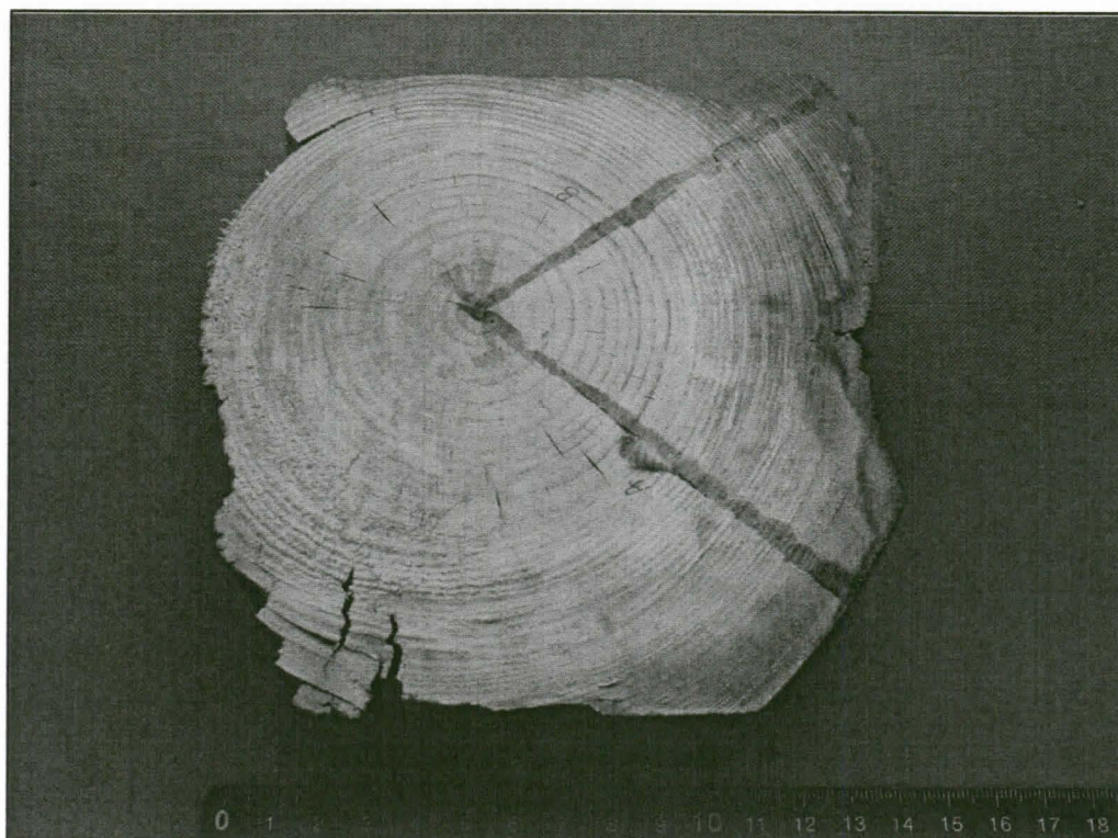
Liitekuva 1. Dendrokronologinen näyte F1T1001, sivuilta veistetty hirsi jossa varaus (oikealla).
