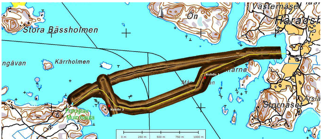
Kartta 8. Mosaiikkikartta Haradsholmenin ja Sandön välisestä luotauksesta. Yläpuolella oleva suora luotaus on olemassa olevien kaapeleiden luotauslinja ja alapuolelta kulkeva, keltaisella merkitty linja on suunniteltu kaapelilinjauks. Karttapohja: Maanmittauslaitos peruskartta.
