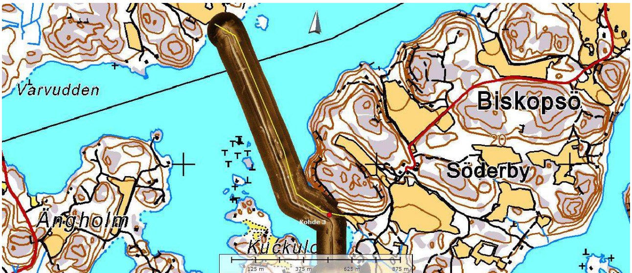
Kartta 9. Mosaiikkikartta Biskopsön ja Grännäsin välisestä luotauksesta. Keltaisella merkitty linja on ehdotus uudelle kaapelilinjaukselle niin että se kiertää kohteen 3 turvallisen matkan päästä. Karttapohja: Maanmittauslaitos peruskartta.
