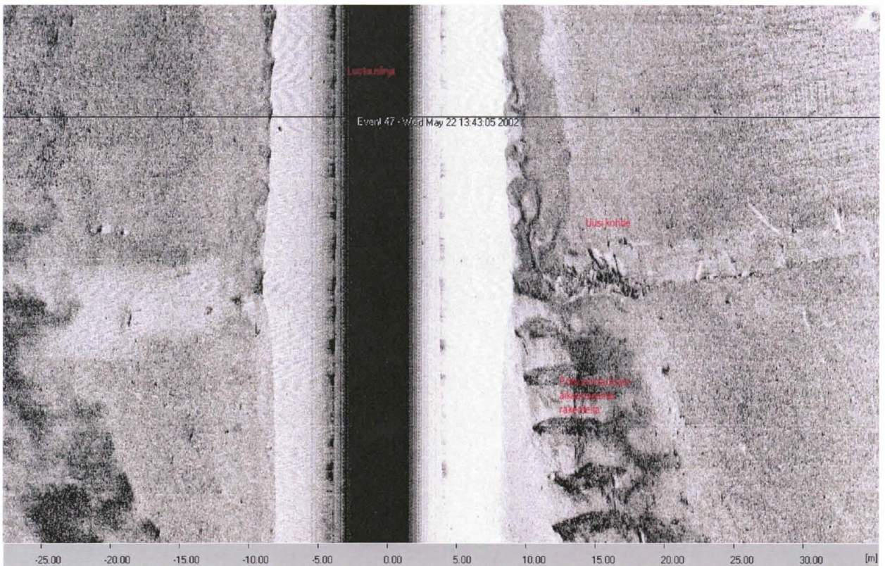
Kuva 10. Pikisaaren hylin väyläalueen eteläosassa havaittu uusi kohde viistokaikuluotaimen (500 kHz) kuvassa. Kohde nähtynä ennen reittipistettä 47 nähtynä. Luotaussuunta alhaalta ylös (lounas-koillinen). Kohteen oikealla puolella näyttäisi olevan jonkinlainen raahautumis-/valumisjälki. Alusten potkurivirtauksien aikaansaamat "aallonmerkit" näkyvät myös hyvin.
