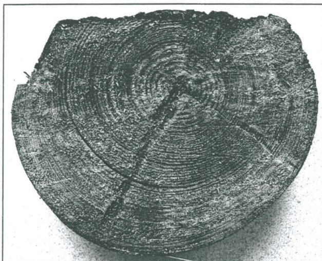
Kuvat 10 ja 11. Dendrokronologisessa näytteessä F4T0024 (vasemmalla) näkyy tummana kolme reaktiipuuvyöhykettä, jotka paljastavat puun kallisuneen kasvaessaan. Oikealla on ajoitusnäyte FIT0025.
