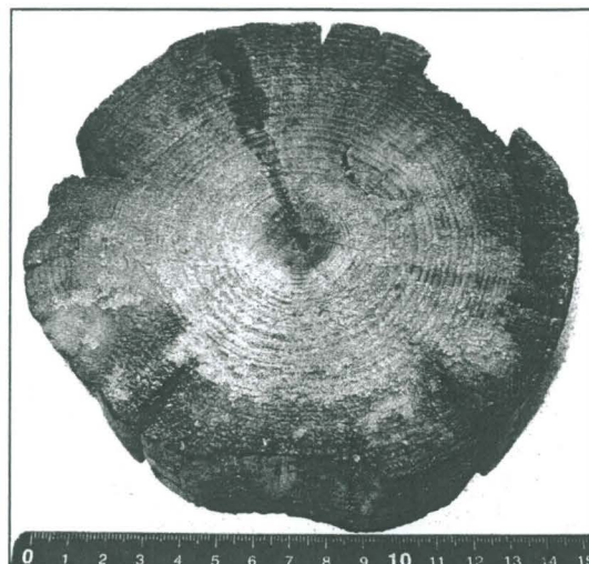
Kuvat 10 ja 11. Dendrokronologisessa näytteessä F4T0024 (vasemmalla) näkyy tummana kolme reaktiipuuvyöhykettä, jotka paljastavat puun kallisuneen kasvaessaan. Oikealla on ajoitusnäyte FIT0025.
