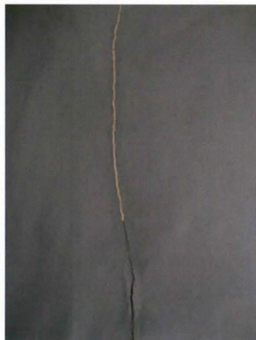
Kuva 39. Repeämä liimauksen jälkeen.
