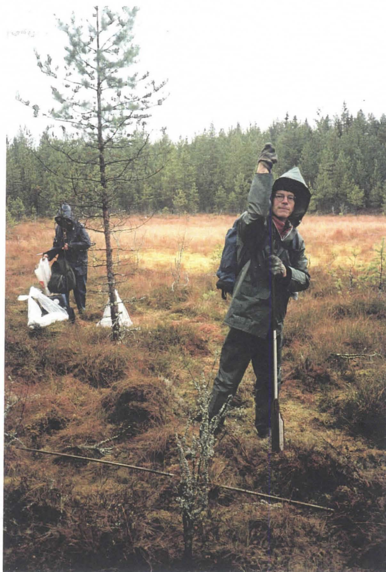
Kuva 5. Sateista Rottasuota näytekohteesta pohjoiseen. Taustalla näkyy nevavaiheessa oleva umpeenkasvanut lampare sekä suotyyppin muutos pienen männyn kohdalla saravaltaisesta nevasta rahkasuoksi. Kairan alaosassa näkyy osa 0,5 m pitkää kairakannua, jolla näyte kerätään. Etumaastossa kairan jatkovarsi. Näytteet kuljetettiin suolta muoviin pakattuina.
