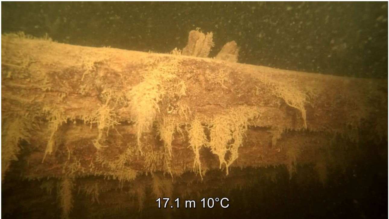
Kuva 13. Kylkilaudoitus auennut lähellä perää paapuurin puolella.
