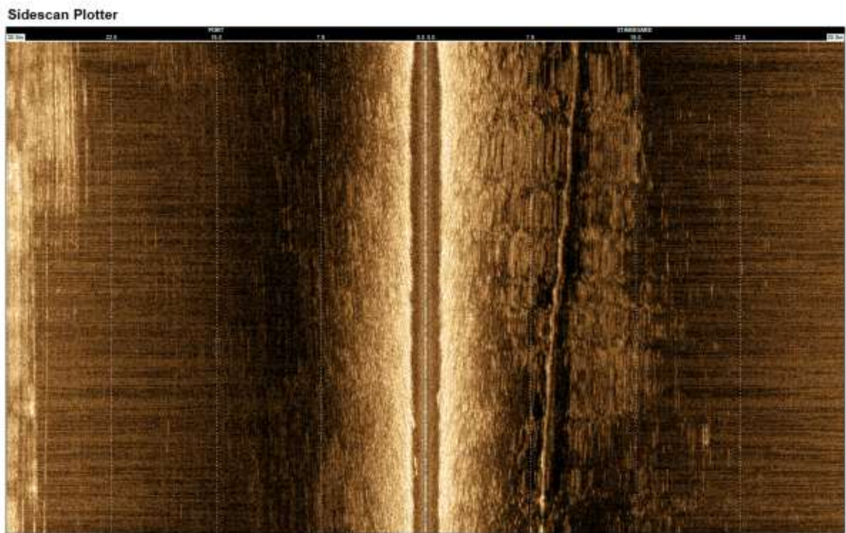
Kuva 6. Viistokaikukuvassa oikealla erottuva vedenalainen vesi- tai viemäriputki inventointialueen pohjoisosassa. ©ARK-sukellus
