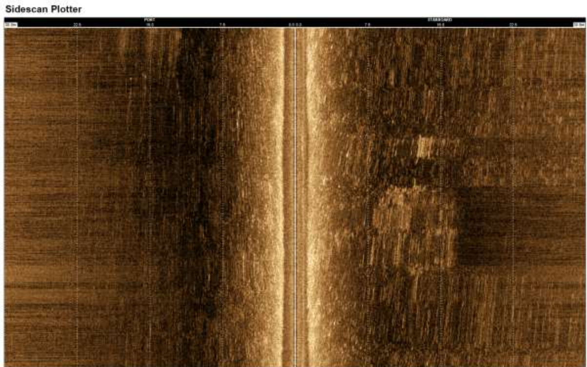
Kuva 7. Viistokaikukuvassa oikealla kaksi kohdetta, jotka todettiin tarkastussukelluksella vedenalaisen kasvillisuuden rajaamiksi alueiksi. Ks. Liite 2, ”tarkastuskohde”. ©ARK-sukellus
