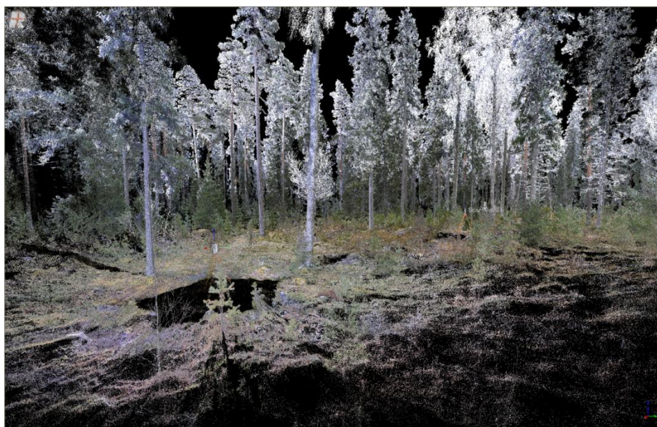
Kuva 3. Riegl VZ 400-laitteen tuottamaa värillistä pistepilvää.
