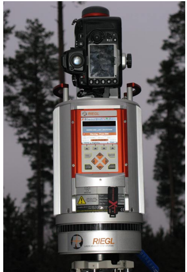
Maalaserskannauslaite RIEGL ja siihen kiinnitetty digikamera. Kuva SKAIK & Museovirasto/Satu Koivisto.
