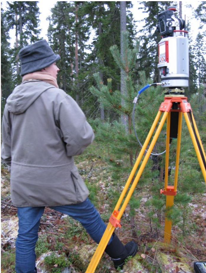
Inventointimenetelmien kehittäminen. Maalaserskannus käynnissä, kuvassa Nina Heiska (TKK/Geocenter Oy). Kuva SKAIK & Museovirasto/Satu Koivisto.
