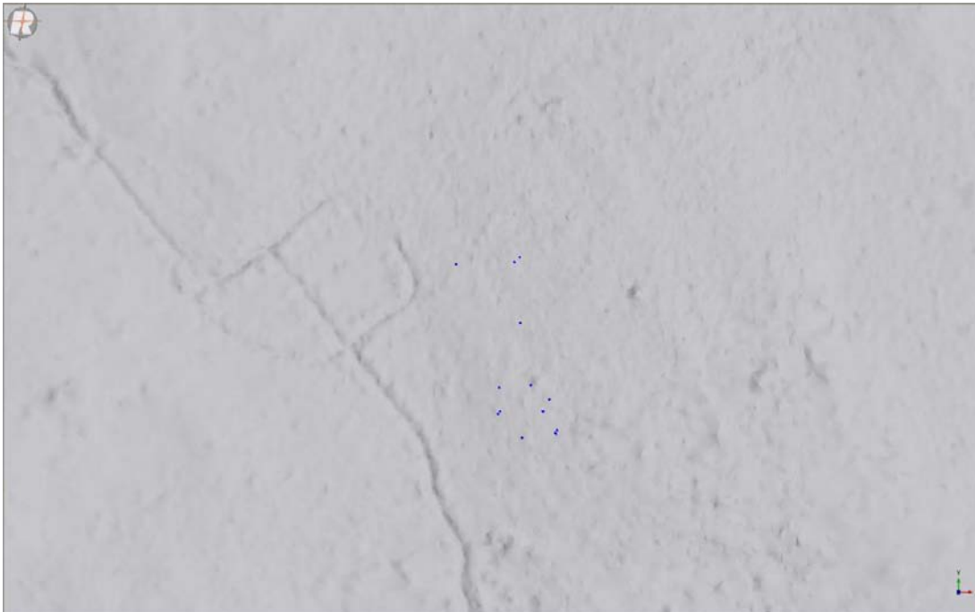
Kuva 4. RiScan Pro-ohjelmasta otettu kuvakaappaus pintamallista, jossa siniset pisteet kuvaavat paikalla GPS-mitattuja kohteita (Seppälä ja Koivisto/SKAIK 2009)
